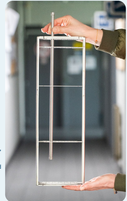
Bei der Gamma-Technologie kommt Kobalt-60 zum Einsatz, eine radioaktive Quelle, die sicher in doppelwandigem Edelstahl eingekapselt ist und oft als „Bleistift“ bezeichnet wird (hier leer).
